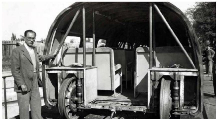
Figura 4. Sistema de rodadura implementado en el prototipo Talgo I.
